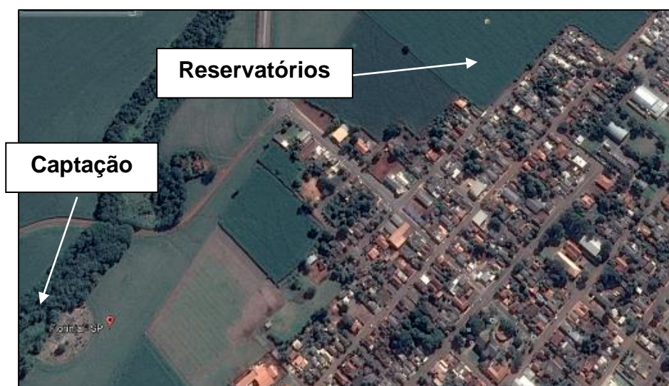
Figura XXX - Sistema de Captação e Reservação
