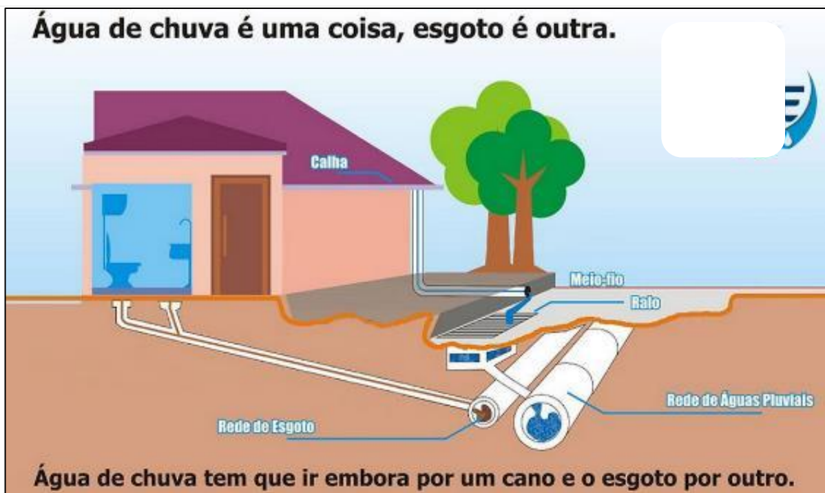
Figura XCII – Esboço do sistema de drenagem e esgoto.
